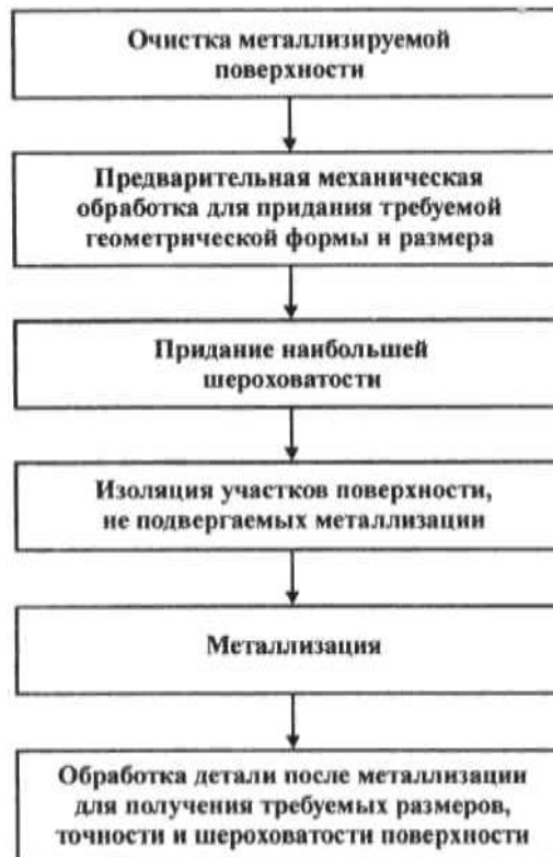
рис.6.9 Схема технологического процесса металізації поверхні деталі
