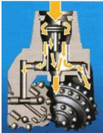
Рисунок 3.2 — Схема руху промивної рідини через бурове долото під час прямого промивання
