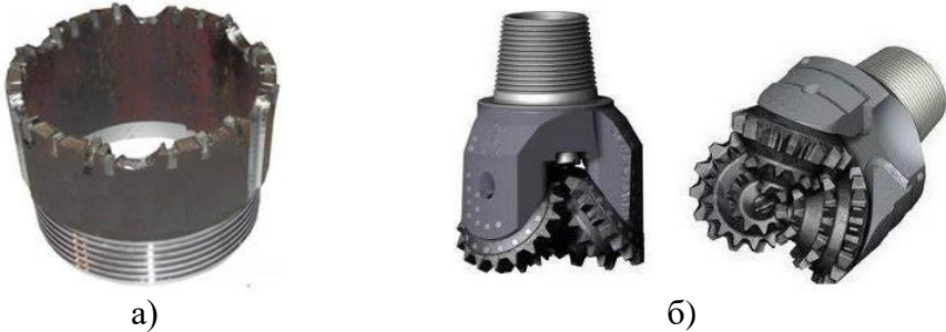
Рисунок 2.3 — Породоруйнівний інструмент: а) бурова коронка; б) тришарошечне долото
