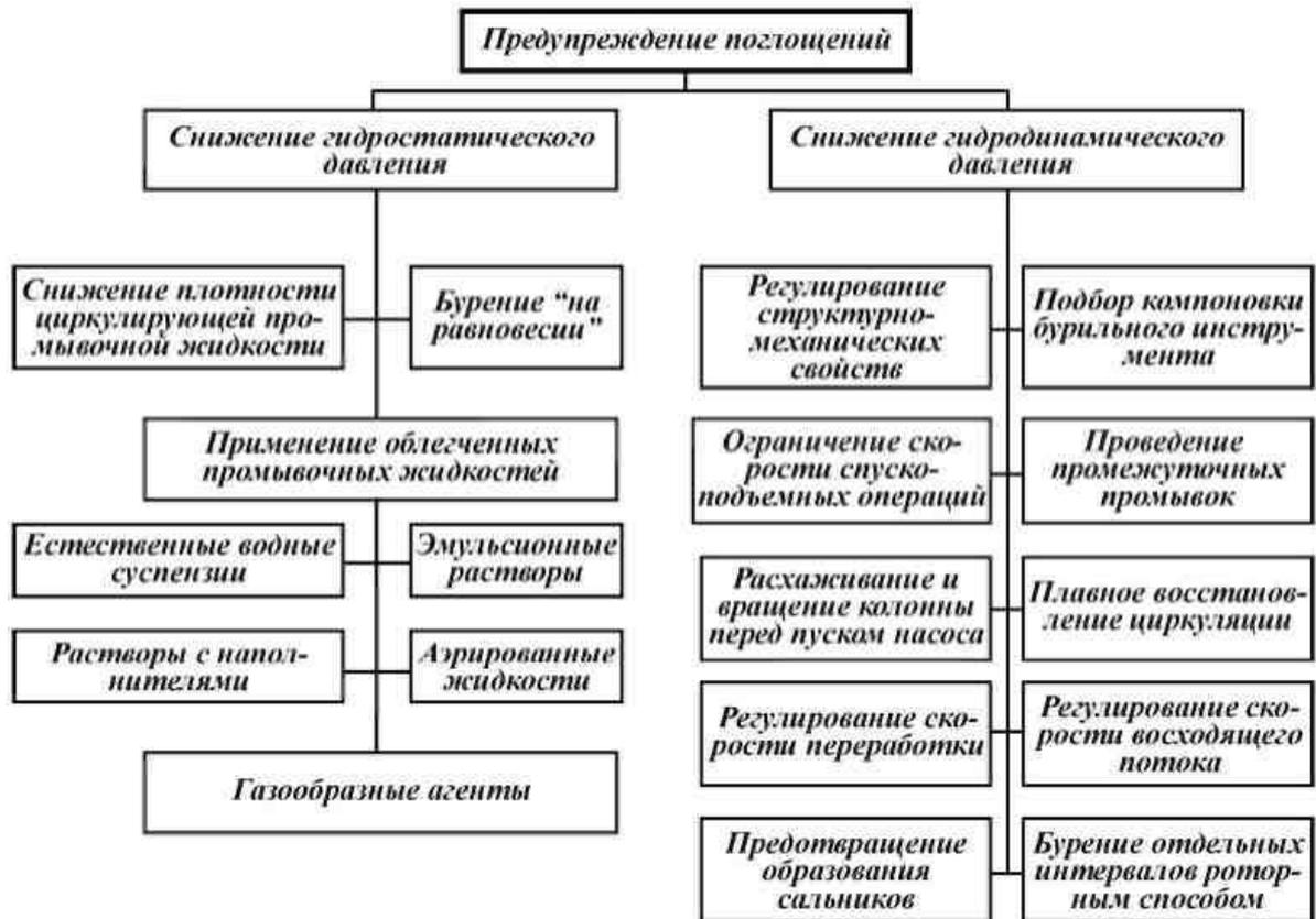
Рис. 1 - Схема факторов, обуславливающих снижение гидростатического и гидродинамического давлений на стенки скважины
