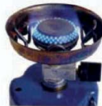
В походной горелке используется бутан, вырабатываемый из природного газа
